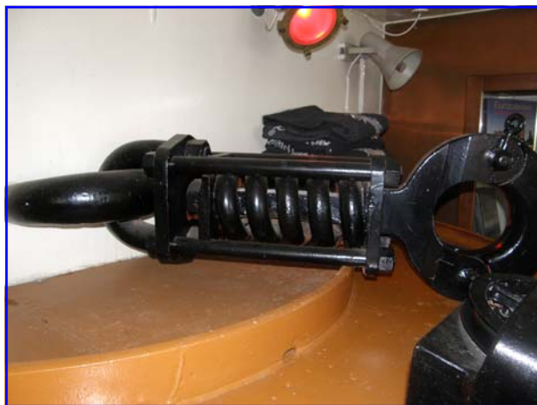
Elbjørn bugserede også skibene gennem isen, så der var virkelig brug for noget kraftigt gods. Denne krog er til trossen agterud
